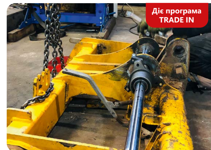
Процес реставрації важеля активної підвіски обприскувача
