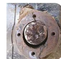
Вихід з ладу підвіски обприскувача
